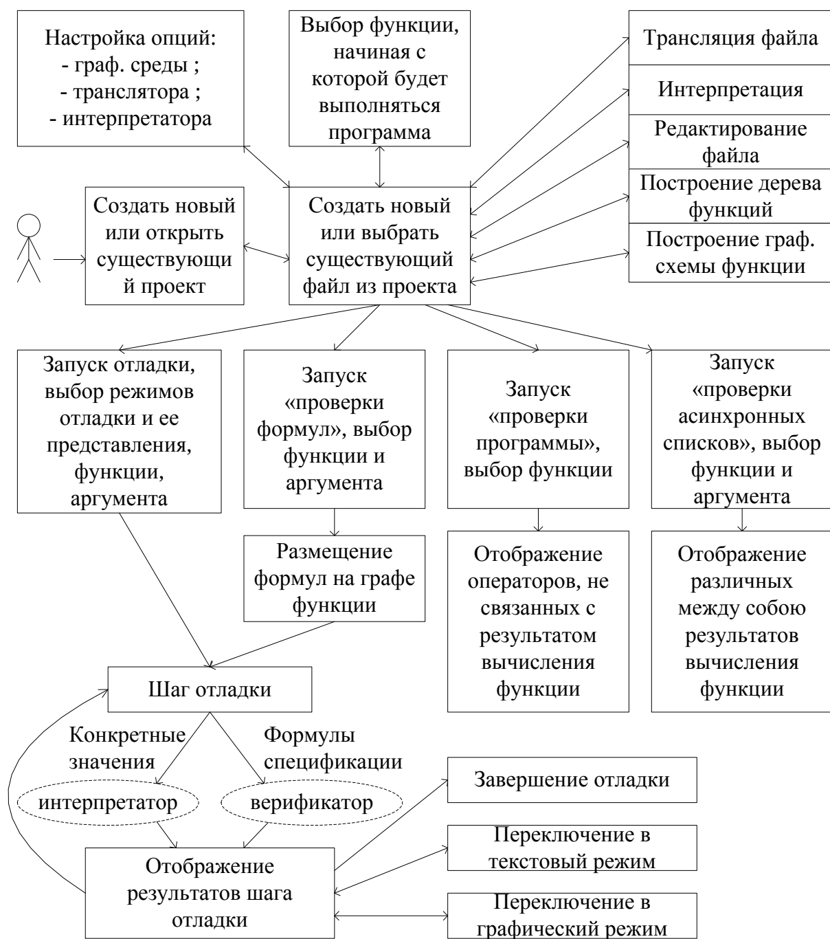
Рисунок 5.4 – Диаграмма запросов пользователя к интерфейсу блока управления
