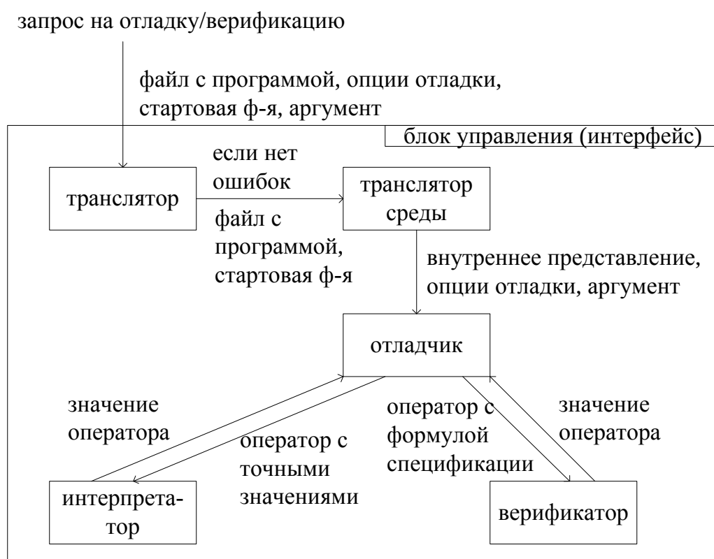
Рисунок 5.1 – Модули среды разработки, отладки и верификации ФПП программ
