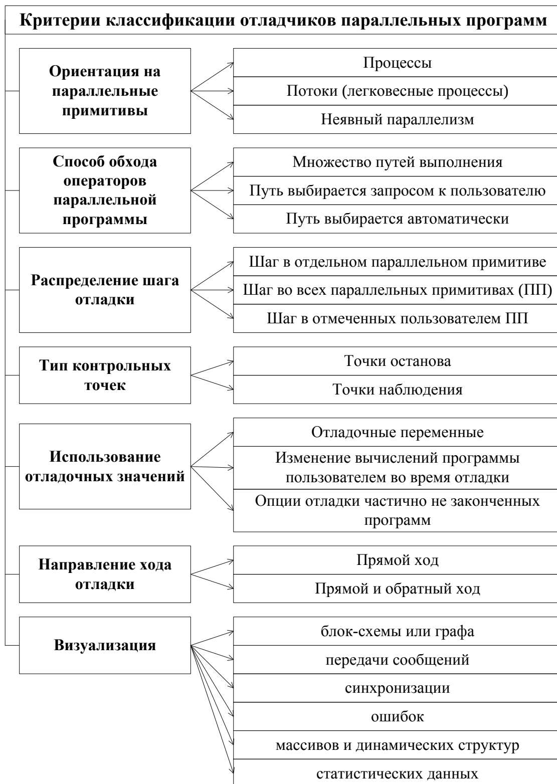
Рисунок 1.1 – Критерии классификации отладчиков параллельных программ
