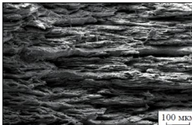
Рис. 5. Результаты механических испытаний (а) и фрактографических исследований компактов на основе алюминия (б), полученных горячей прокаткой в трубчатых контейнерах
