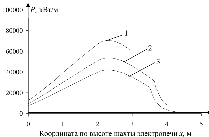
Рисунок 3 - Распределение мощности химических реакций P_x по координате x (см. рисунок 1) в зависимости от высоты H реакционной зоны печи: 1 - H = 2\text{м} ; 2 - H = 3\text{м} ; 3 - H = 4\text{м} ; 4 - H = 5\text{м} .
