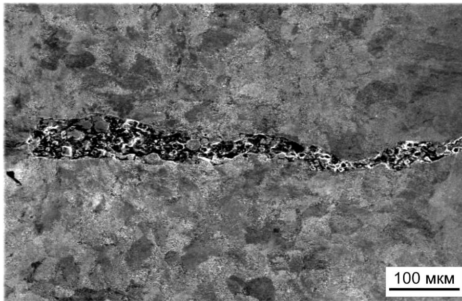
Рисунок 3.28 – Трещина, заполненная продуктами разрушения
