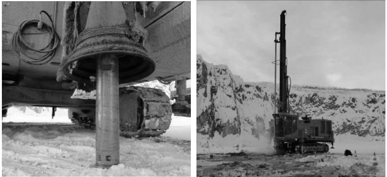
Рисунок 8.3 – Пневмоударник ПВ 170М, установленный на буровом станке SWDB165
