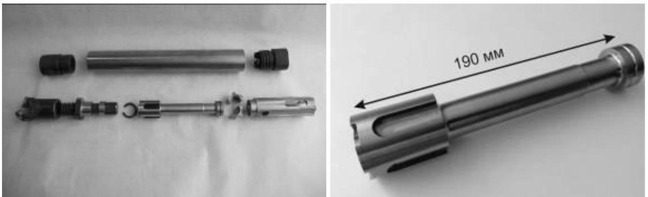
Рисунок 4.26 – Конструкция экспериментального образца малогабаритного погружного пневмоударника АШ43Т (а) и бойка, изготовленный из сплава ОТ4-1 (б).
