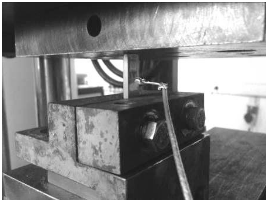
Рисунок 2.15 – Калибровка измерительной системы в условиях сжатия на комплексе Instron 300DX
