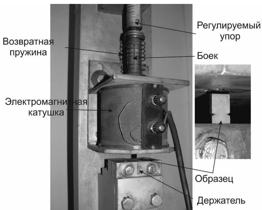
Рисунок 2.7 – Внешний вид установки с держателем образцов, используемым при испытаниях на ударно-циклическое сжатие
