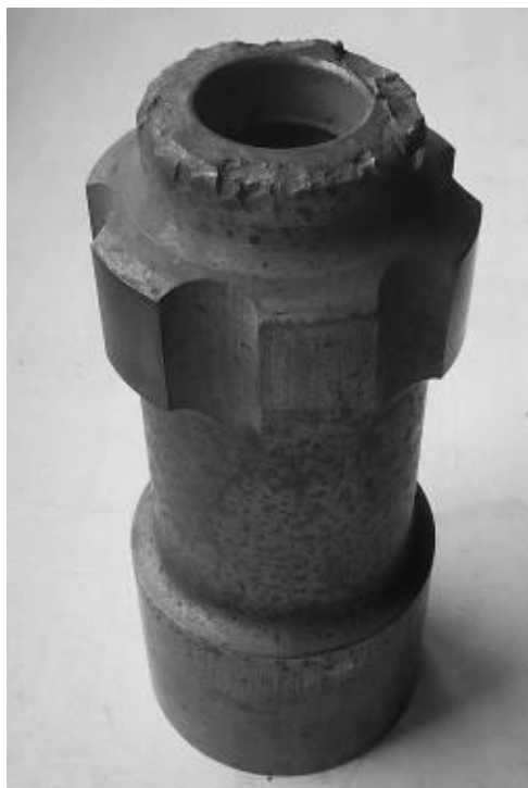
Рисунок 7.1 – Разрушенный боек пневмоударника со следами коррозионного повреждения.
