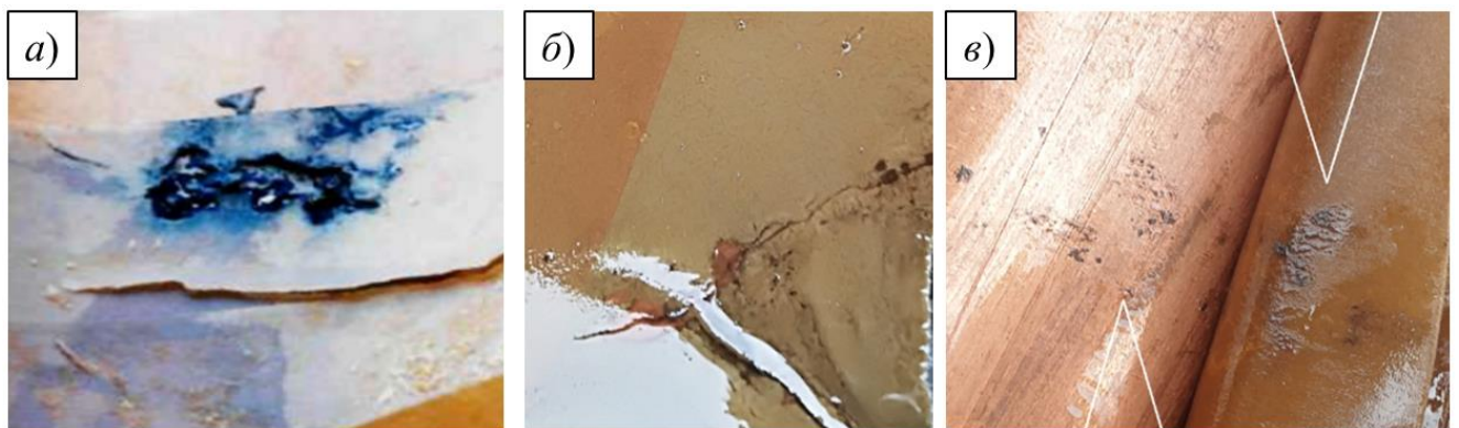
Рисунок 3.12 – Воскообразные отложения между слоями бумажно-масляной изоляции: а) высоковольтный ввод 220 кВ с маслом ГК [330]; б) высоковольтный ввод 110 кВ с маслом Т-750 (ПАО «ФСК ЕЭС») [299]; в) высоковольтный ввод 110 кВ с маслом ГК (ПАО «ФСК ЕЭС»)
