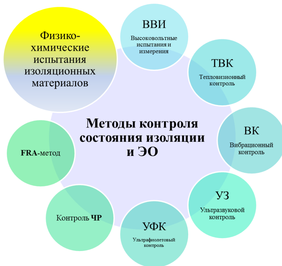
Рисунок 1.38 – Методы диагностики состояния изоляции электрооборудования
