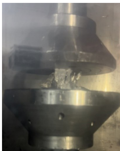
Рисунок 4.9 – Разрушение образца льда при испытании на одноосное сжатие в универсальной испытательной машине BiSS 00-101
