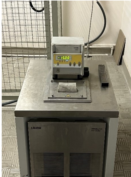
Рисунок 4.1 – Термостат LAUDA Proline RP 890 для поддержания постоянной температуры
