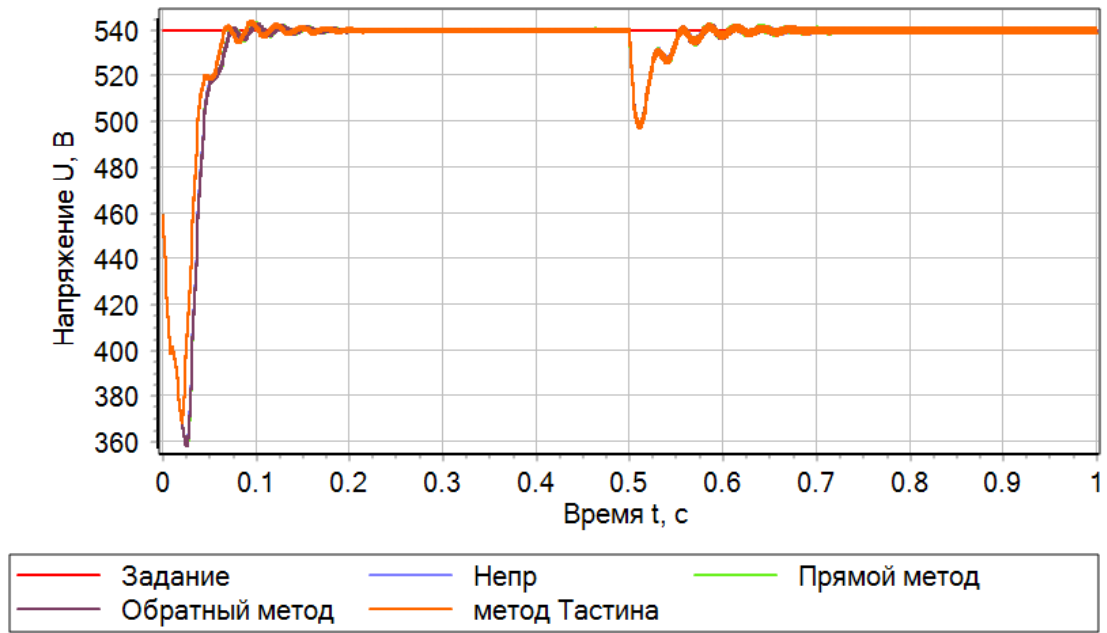
Рисунок 4.72 – Напряжение на выходе преобразователя при напряжении входа 380 В
