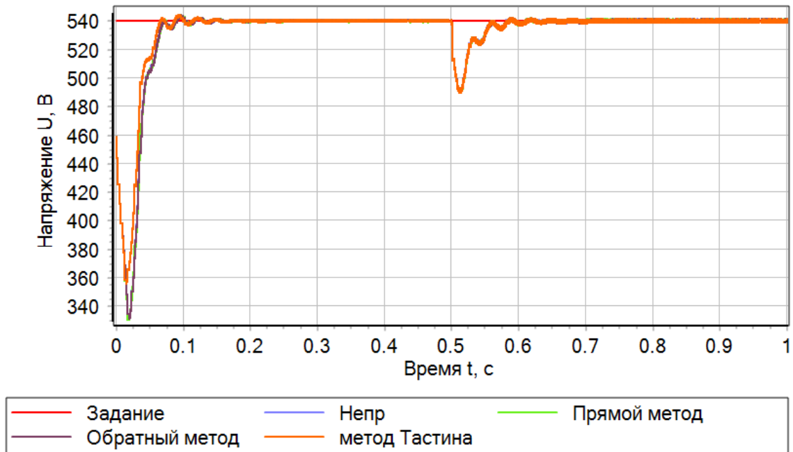
Рисунок 4.70 – Напряжение на выходе преобразователя при напряжении входа 320 В
