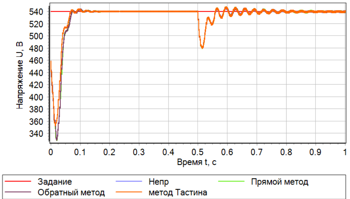
Рисунок 4.68 – Напряжение на выходе преобразователя при напряжении входа 260 В
