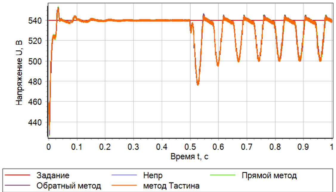
Рисунок 4.59 – Режим автоколебаний на выходе преобразователя при напряжении входа 200 В
