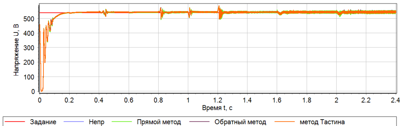
Рисунок 4.92 – Напряжение на выходе преобразователя с коррекцией частоты сопряжения
