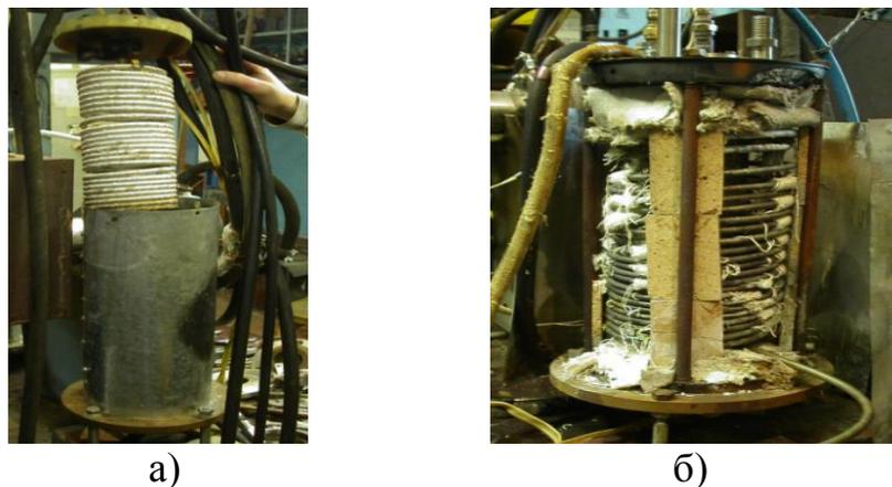
Рисунок 5 – Фотографии нагревателя воздуха а) и парогенератора б)
