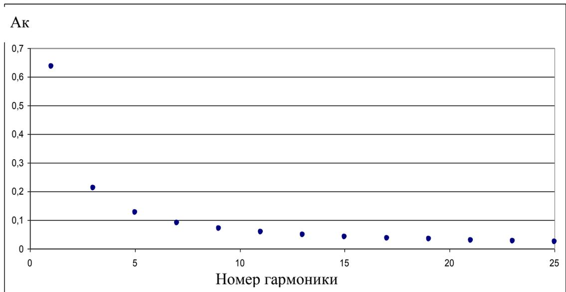
Рисунок 5 – Спектр прямоугольного профиля заготовки
