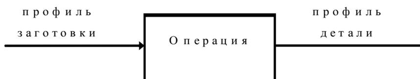
Рисунок 1 – Технологическая операция как система для преобразования исходного профиля заготовки в профиль детали
