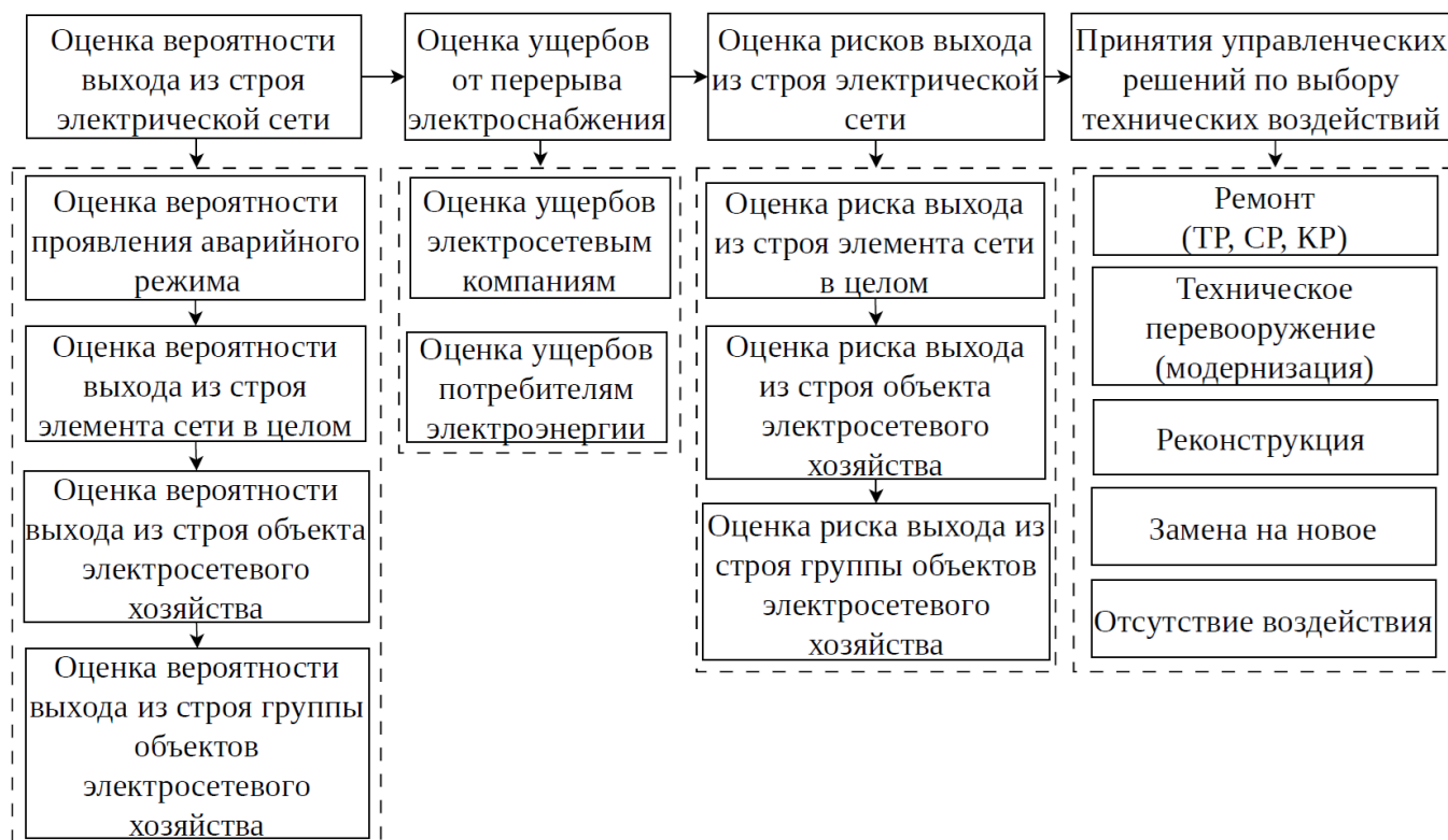
Рисунок 1 – Структурная схема риск-ориентированной системы управления техническим состоянием электрических сетей
