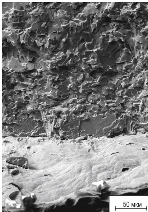
Рисунок 2 – Фрактограммы изломов поверхностных слоев, модифицированных методом ВЭЛН. Наплавка в присутствии железа при I = 23 мА
