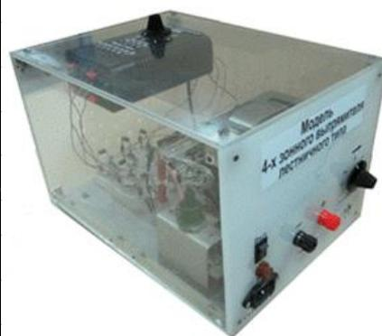
Сравнение результатов экспериментов на физических моделях однофазного четырехзонного преобразователя с мостовой и лестничной структурой подтвердило, что лестничные схемы имеют более высокие значения коэффициента мощности, чем мостовые схемы преобразователей в среднем на 2 – 4 %.
