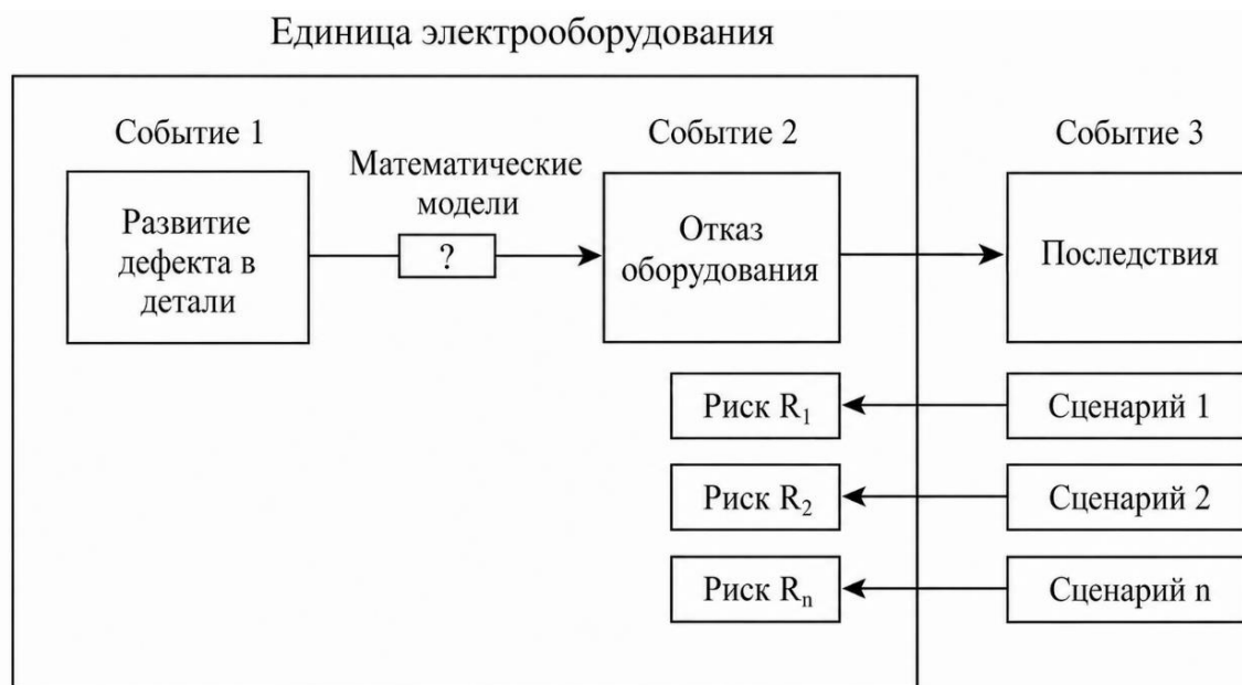
Рисунок 1 – Причинно-следственная связь между дефектами и отказами элементов СЭС
