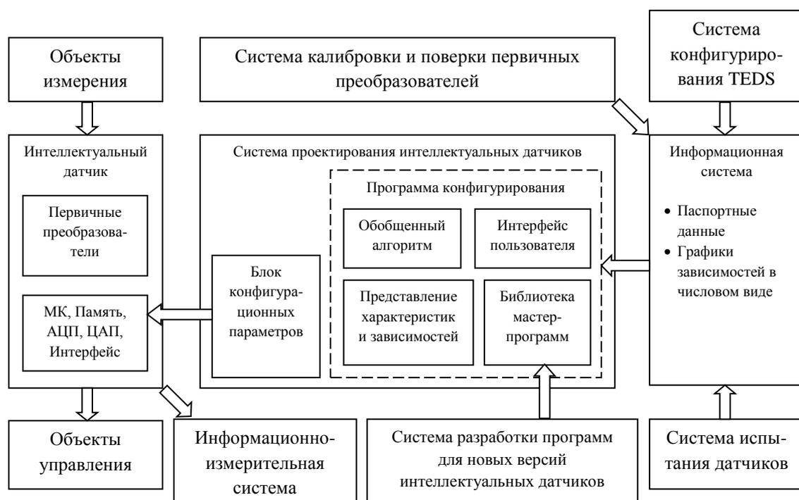
Рисунок 6 – Схема системы проектирования реконфигурируемых интеллектуальных датчиков
