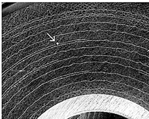
Рисунок 8 – Внешний вид образца RIP изоляции (а) и проникновение красящей жидкости (б) по сквозному капилляру (показан стрелкой)
