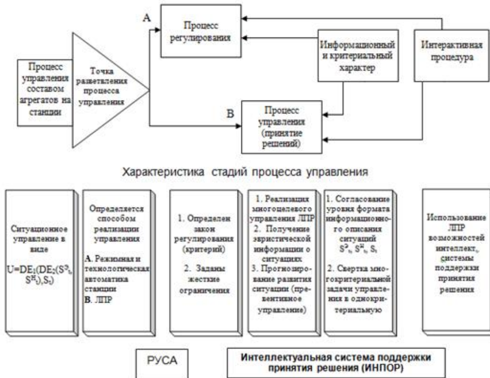
Рисунок 1 – Ситуационное управление составом агрегатов на станции
