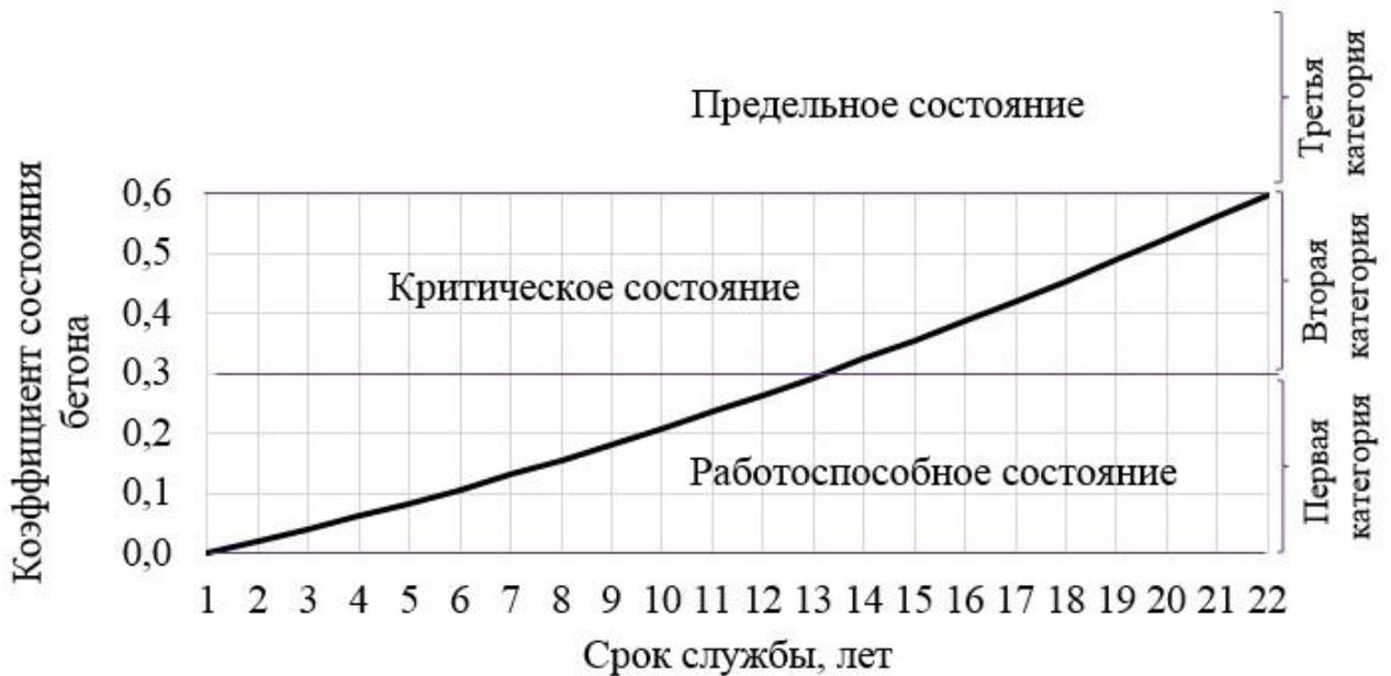
Рисунок 1 - Пример изменения параметра фактического состояния железобетонных опор
