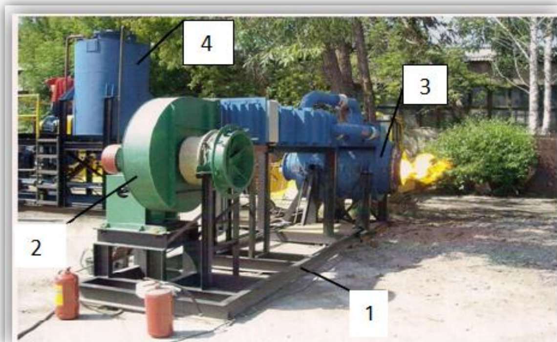
Рисунок 1.15 - Испытательный стенд с тепловой мощностью горелочного устройства 6,5МВт
