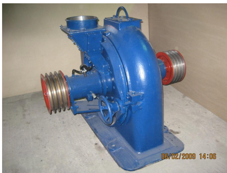
Рисунок 1.10 - дезинтегратор для производства 3 т/ч ТД ВУС
