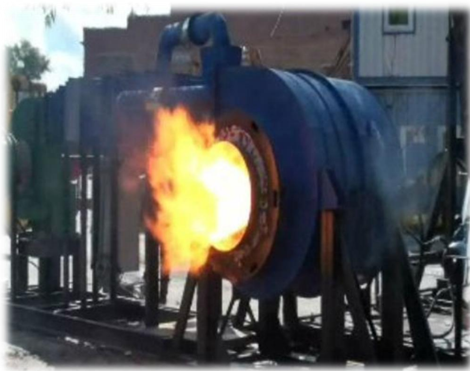
Рисунок 1.16 - Циклонный предтопок для котла, тепловой мощностью 6,5 МВт
