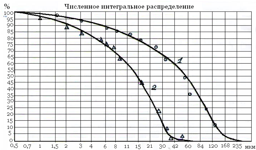
Рисунок 1.4 - Гранулометрический анализ угольного порошка после дезинтегратора:
