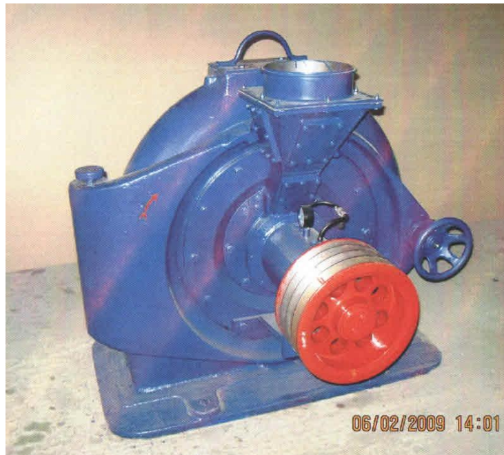
Рисунок 1.5 - Дезинтегратор производительностью 5 т/ч
