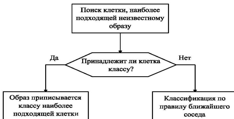
Рисунок 3.4 – Схемы классификаций для самоорганизующегося отображения
