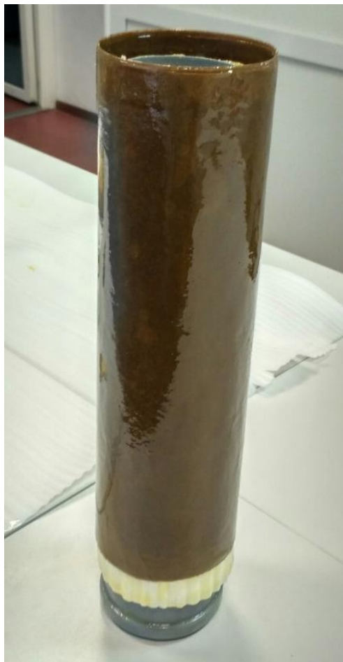
Рисунок 5.20 – Изготовленный на основе эпоксидного компаунда теплоизолированный каркас для намотки сверхпроводящей ленты
