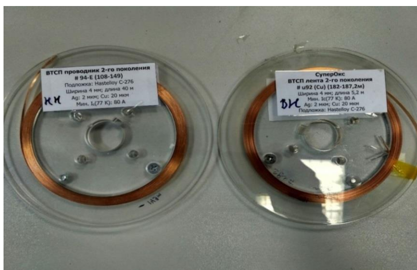
Рисунок 5.19 – Сверхпроводящая YBCO лента
