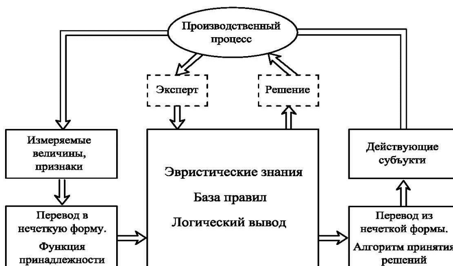
Рисунок 3.2 – Схема нечеткой диагностической системы
