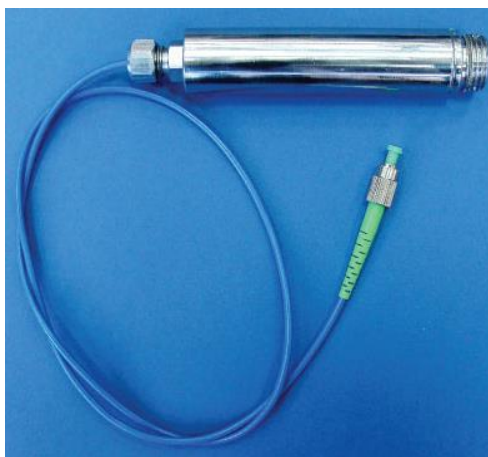
Рисунок 1.10 – Волоконно - оптический датчик давления серии OSP – 551 [28]
