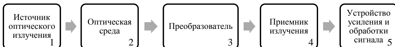
Рисунок 1.1 – Блок схема структуры оптоволоконных датчиков [11]
