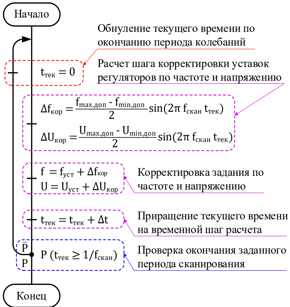
Рисунок 3.7 – Вариант алгоритма сканирования с синусоидальным законом изменения гармонизированных сигналов
