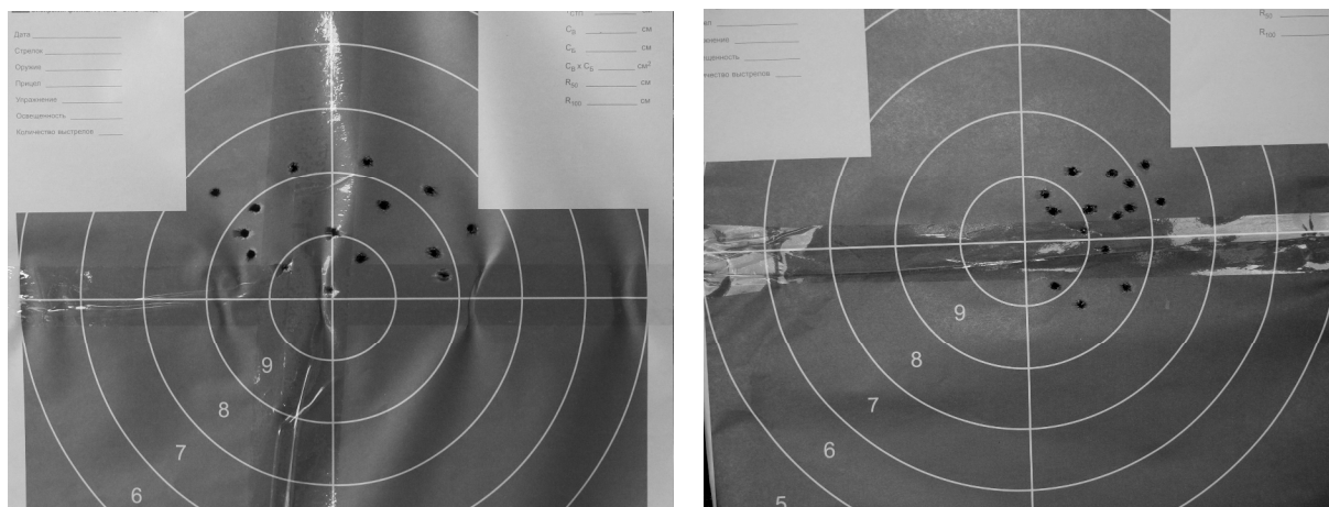
Рисунок 58 – Результаты отстрела с выключенным датчиком наклона (фотография слева) и с включенным датчиком (фотография справа)
