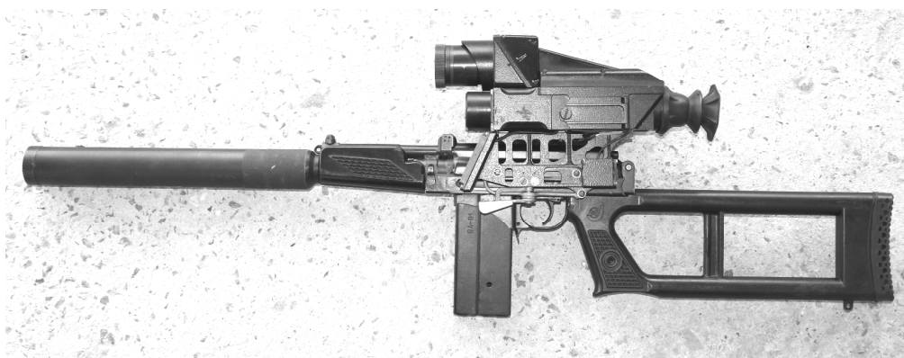
Рисунок 7 – Цифровой прицел Нагель, имеющий встроенный лазерный дальномер
