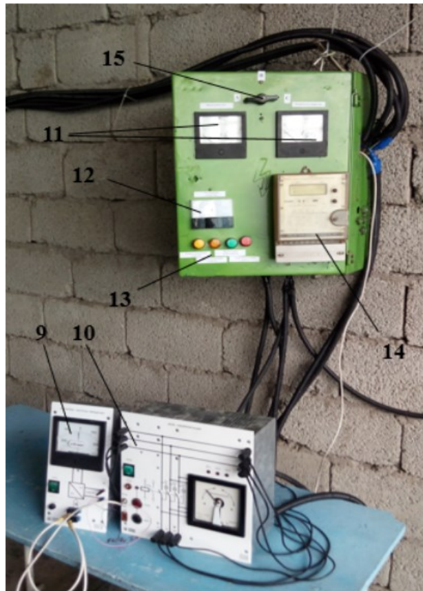
Рисунок 4.9 – Внешний вид экспериментальной установки для испытания системы защиты от механических поломок или попадания инородного тела в гидротурбину
