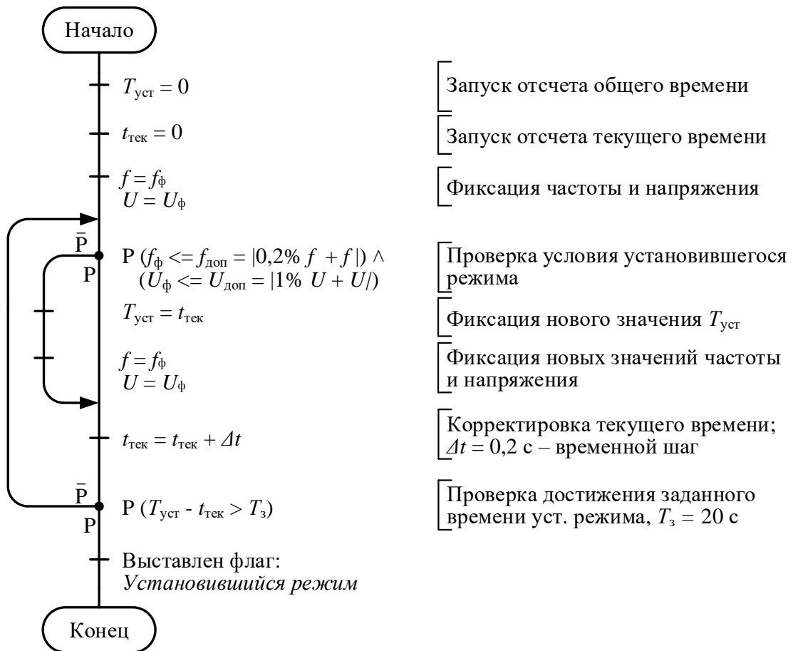
Рисунок 3.3 – Алгоритм идентификации установившегося режима
