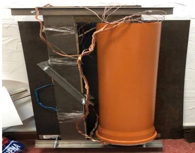
Рисунок 2.6 – Однофазный образец ВТСП трансформатора с полипропиленовым криостатом
