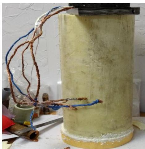
Рисунок 2.7 – Однофазный образец ВТСП трансформатора с полипропиленовым криостатом в теплоизоляционной оболочке из пеноплекса
