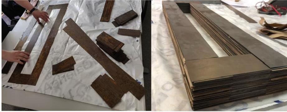
Рисунок 2.4 – Процесс сборки магнитопровода
