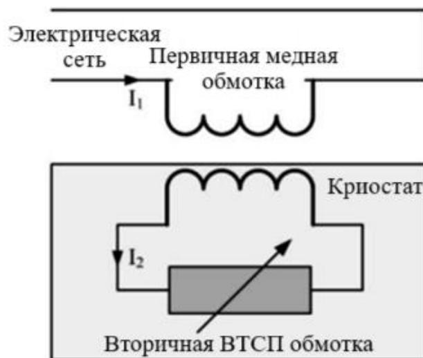
Рисунок 1.8 – Схема конструкции индуктивного сверхпроводящего токоограничителя
