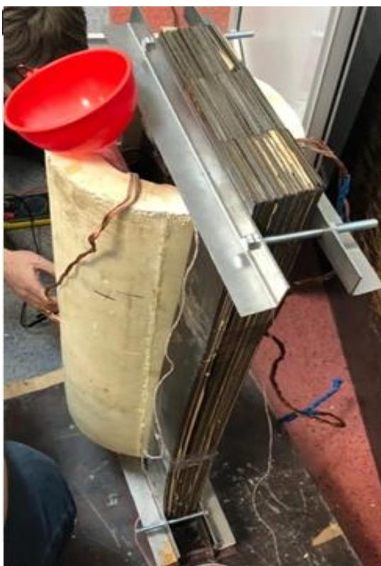
Рисунок 2.8 - Однофазный опытный образец ВТСП трансформатора
