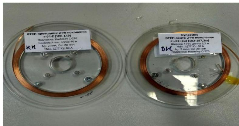
Рисунок 2.2 – Сверхпроводящая YBCO лента производства «СуперОкс»
