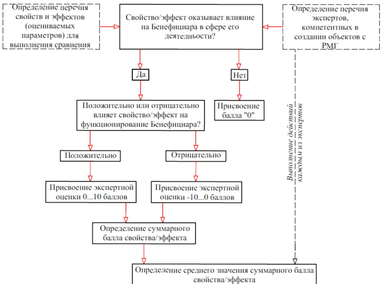
Рисунок 2.3 – Принципиальная схема методики сравнительной оценки вариантов объединения ЛИЭС
