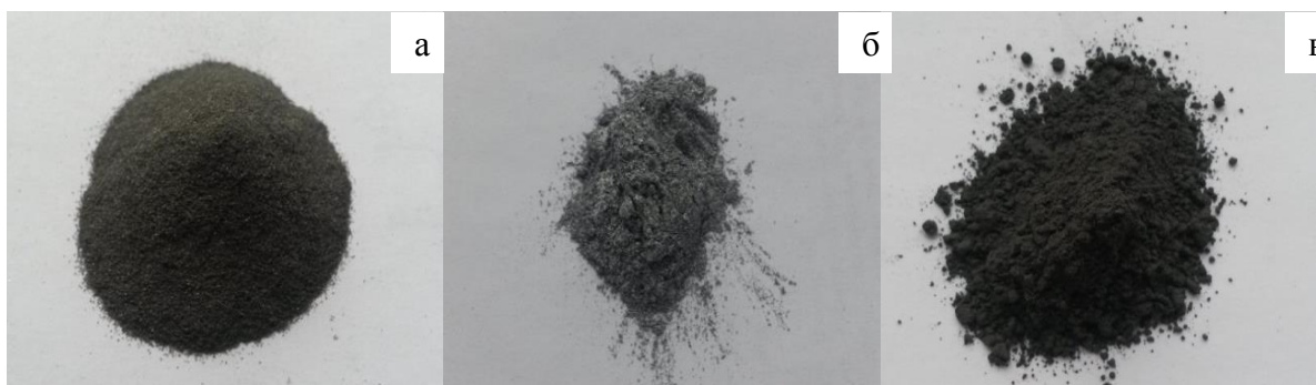
Рисунок 2.1 –Исходные порошки: а) титан, б) алюминий, в) ниобий
