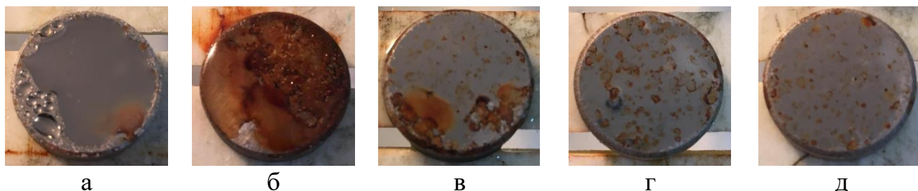
Рисунок 4.8 – Поверхность образцов из нержавеющей стали, углеродистой стали и покрытий Fe_{66}Cr_{10}Nb_5B_{19} , полученных при различных зарядах взрывчатой смеси ( O_2/C_2H_2 \approx 1 ), после испытаний в камере соляного тумана в течение 150 часов:
