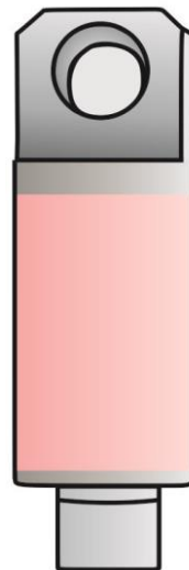
Рисунок 5.2 – Схема штока поршня для плунжерных насосов типа ПТ; поверхность, на которую наносится защитное покрытие, показана розовым цветом
