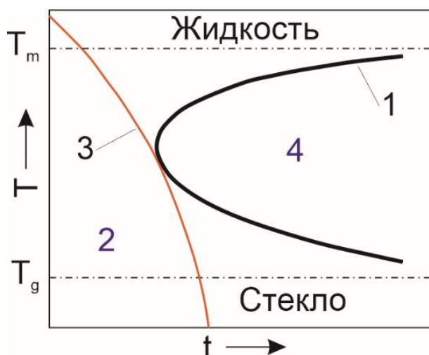
Рисунок 1.1 – Общий вид TTT -диаграммы: 1 – S -кривая начала кристаллизации; 2 – область переохлажденной жидкости; 3 – кривая, соответствующая критической скорости охлаждения, 4 – область кристаллизованного сплава [14]
