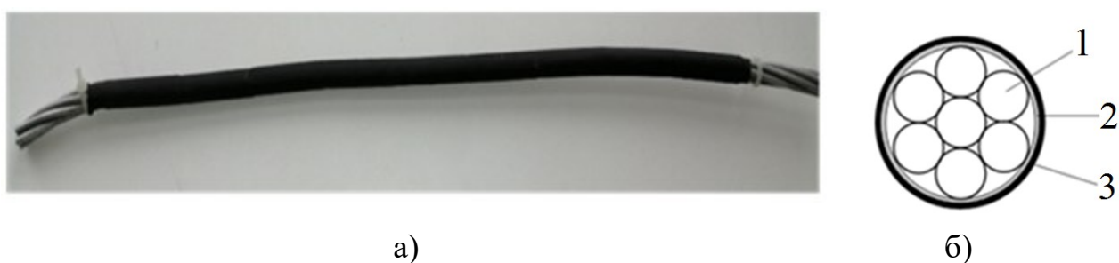
Рисунок 2.12 – Макет круглого проводника: а) фотография образца, б) схема конструкции проводника: 1 – алюминиевый проводник, 2 – ферромагнитный слой, 3 – диэлектрический защитный слой
