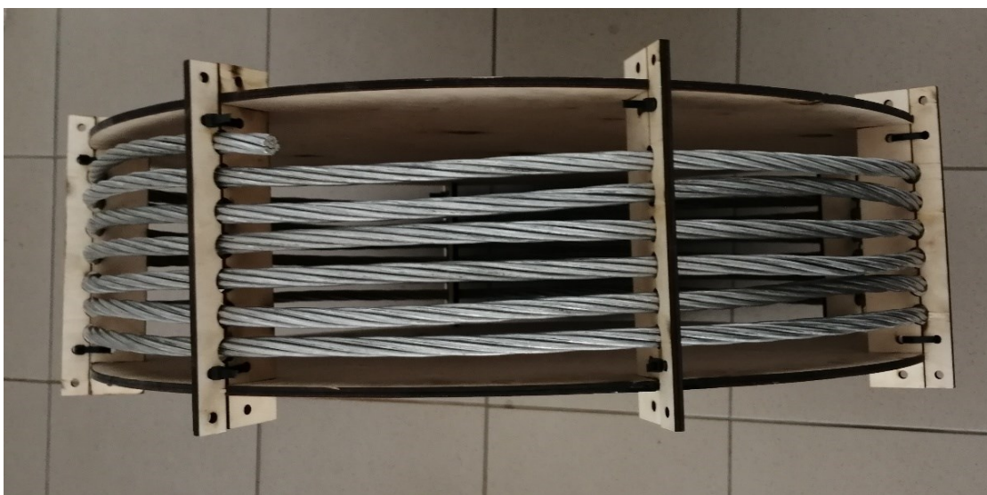
Рисунок 2.28 – Образец без ферромагнитной ленты для сравнения (макет силового реактора)
