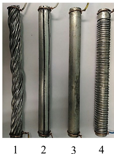
Рисунок 2.7 – Образцы низковольтных испытаний: 1 – образец провода; 2 – образец прута с пазами; 3 – образец гладкого прута; 4 – образец прута с намоткой
