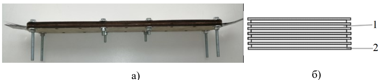
Рисунок 2.13 – Макет плоского многослойного проводника: а) фотография образца, б) схема конструкции проводника: 1 – алюминиевый проводник, 2 – ферромагнитный слой
