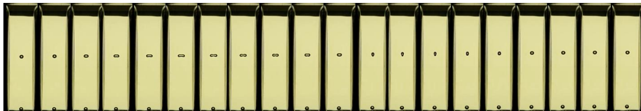
Рисунок 6.14 – Схлопывание пузырька гелия после ЧР при амплитудном значении напряжения 10 кВ
