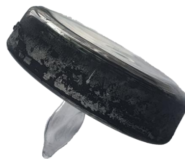
Рисунок 4.2 – Углеродные нанотрубки, осевшие на стенках сосудов
