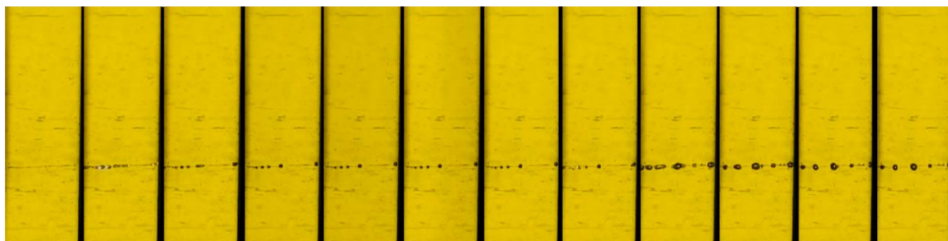
Рисунок 4.8 – Пробой углеродного мостика из агломератов наночастиц
