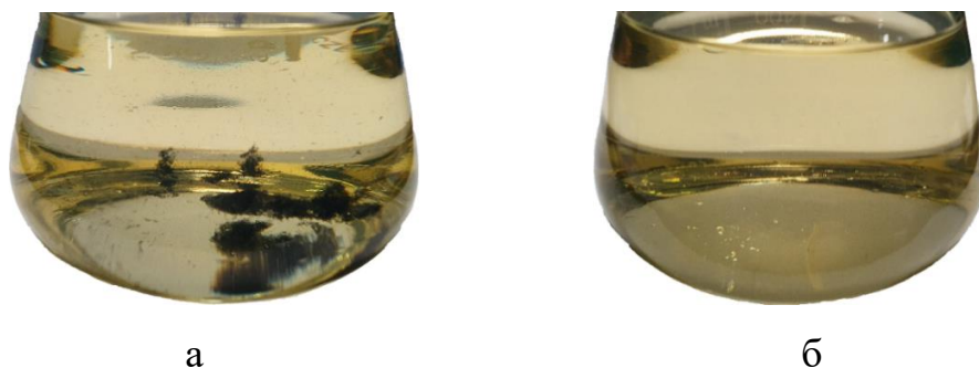
Рисунок 4.5 – Выпадение в осадок диспергированных графеновых нанотрубок
