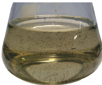
Рисунок 4.4 – Графеновые нанотрубки, добавленные в трансформаторное масло без дополнительной ультразвуковой обработки
