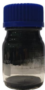
Рисунок 4.2 – Углеродные нанотрубки, осевшие на стенках сосудов
