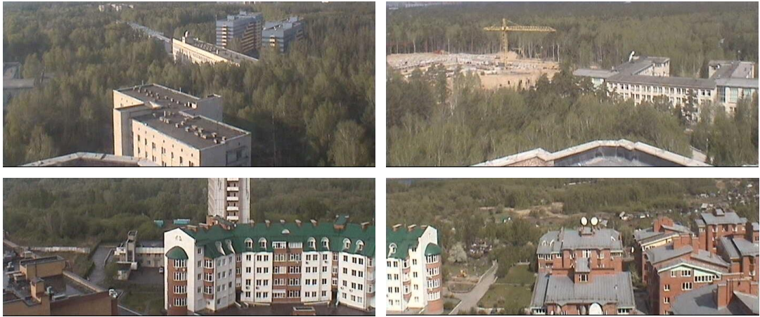
Рисунок 3.42 – Примеры реальных изображений из тестового набора для оценивания эффективности алгоритмов сегментации изображений на области занятые лесом и зданиями
