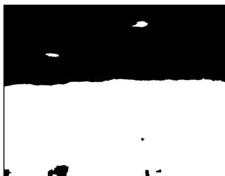
Рисунок 3.9 – Результат сегментации изображения на области, занятые лесом и небом, с применением метода Оцу выбора порога по гистограмме распределения значения параметра S ( t = 13 )
