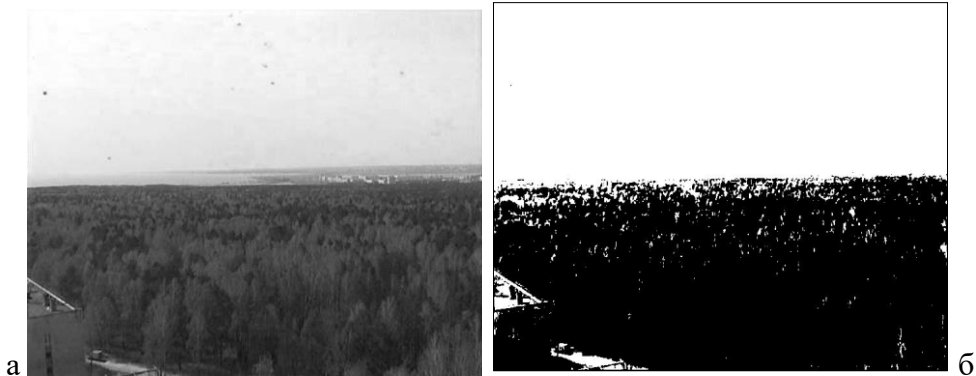
Рисунок 3.32 – Полутоновое изображение (а) и результат сегментации «лес-небо» (б) на основе трехмерного пространства смешанных признаков, включающего признак удаленности пиксела от верхней горизонтальной границы изображения на основе линейной функции (3.17)
