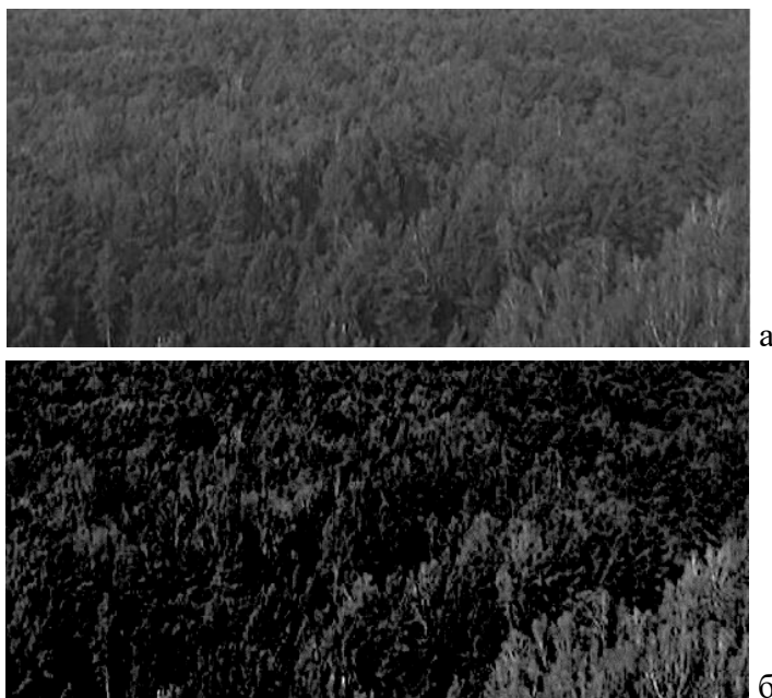
Рисунок 1.22 – Результат (б) линейного выравнивания яркости изображения (а) на основе вычитания оценки средней по строке яркости
