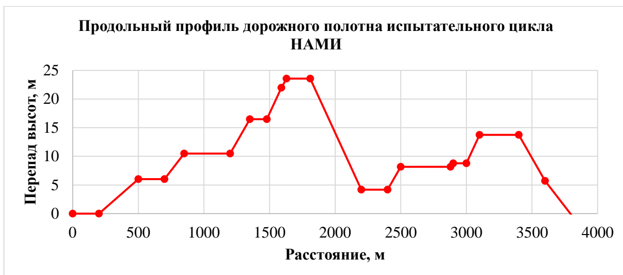
Рисунок 3.10 – Продольный профиль дорожного полотна испытательного цикла
