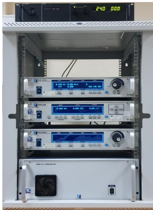
Рисунок 4.6 – Программируемый источник постоянного тока DLM 16-185E для питания обмотки нагрузочной машины
