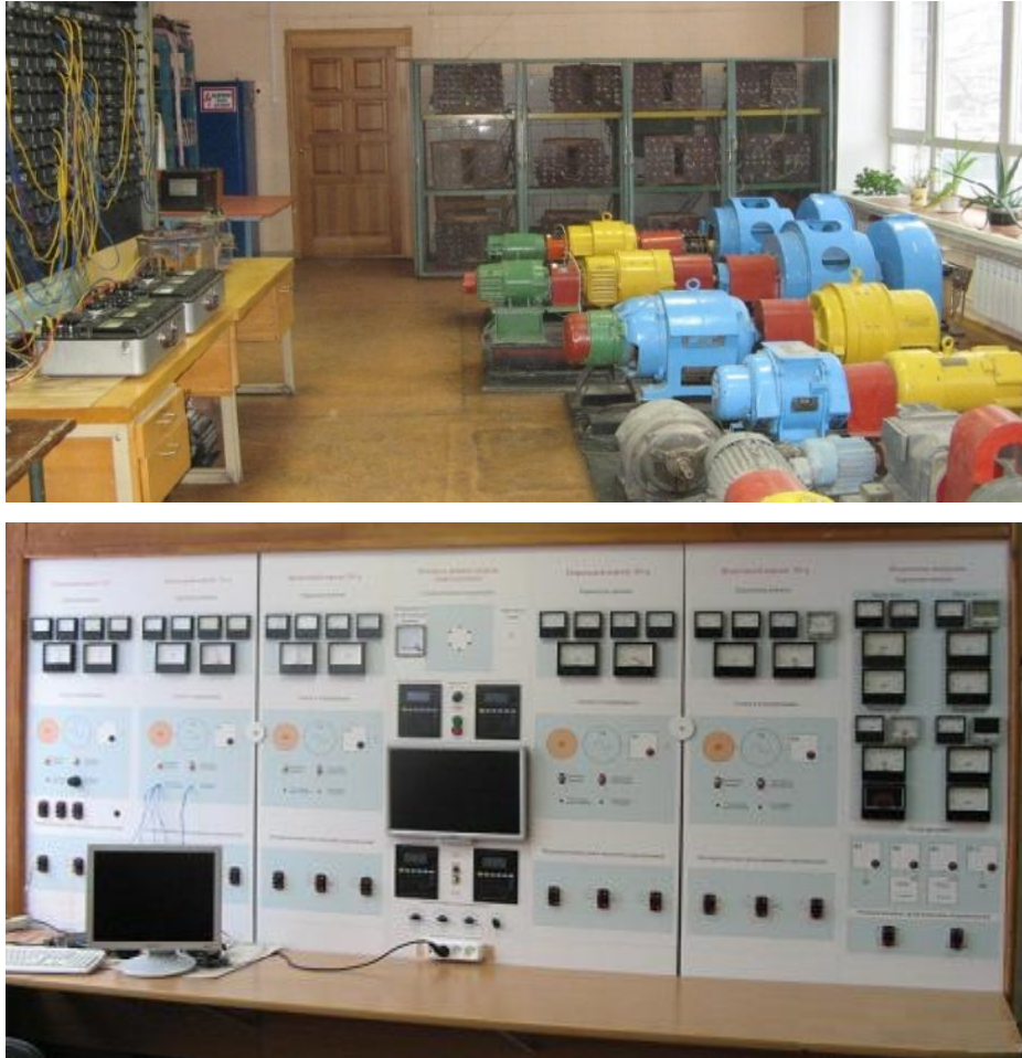
Рисунок 4.6 - Машинный зал электродинамической модели с основными элементами модели объекта и пульт управления
