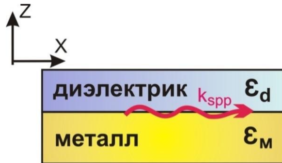
Рисунок 4.2 – Распространение поверхностного плазмон-поляритона на плоской границе раздела металла и диэлектрика с диэлектрическими проницаемостями \epsilon_M(\omega) и \epsilon_d(\omega) соответственно
