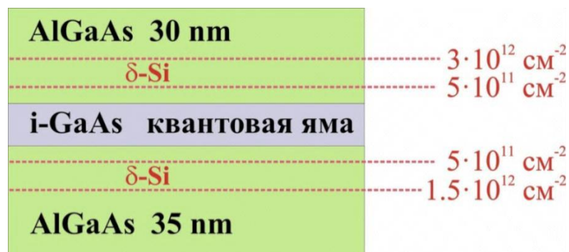
Рисунок 2.11 – Схематическое изображение квантовой ямы GaAs в обкладках \delta -легированного AlGaAs. Пунктирными линиями на рисунке схематически показаны \delta -слои кремния
