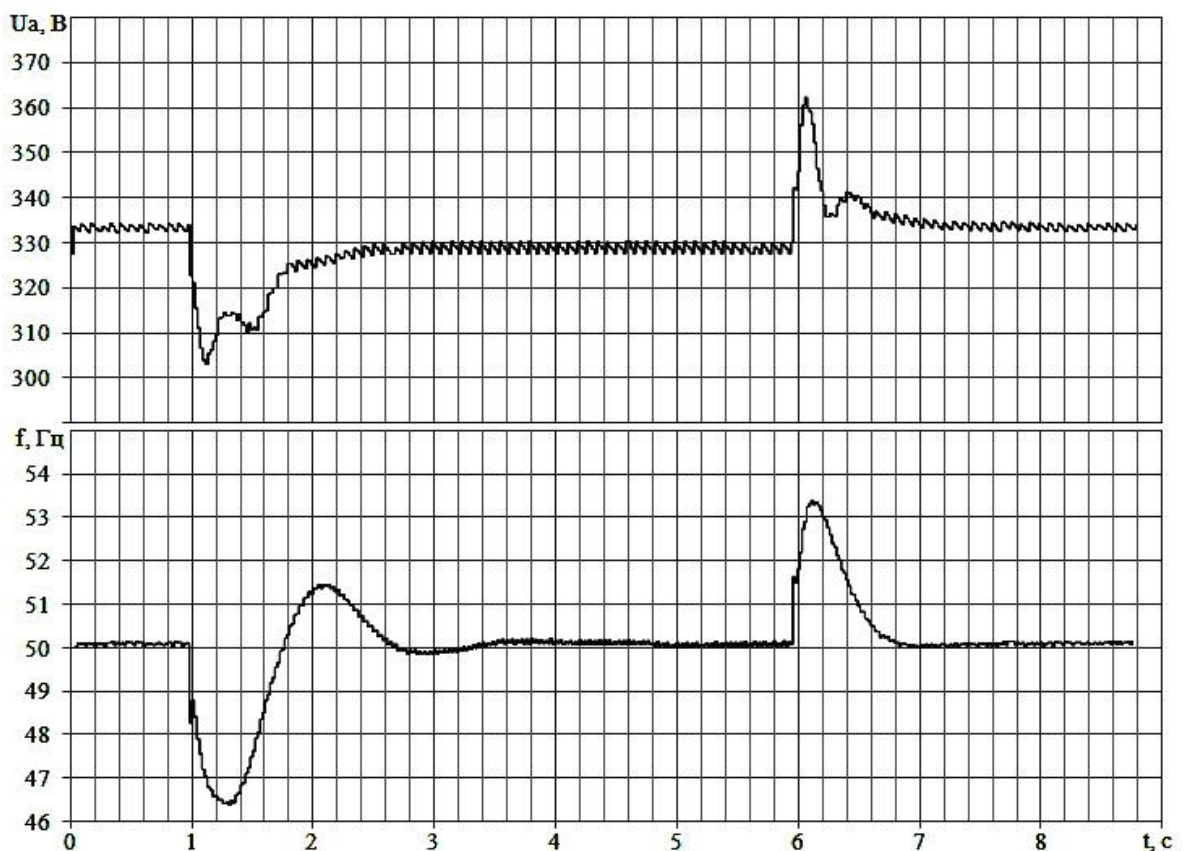
Рисунок 3.3 – Реакция амплитуды U_a и частоты f напряжения фазы А на наброс (1 с) и сброс (6 с) мощности на ДГУ
