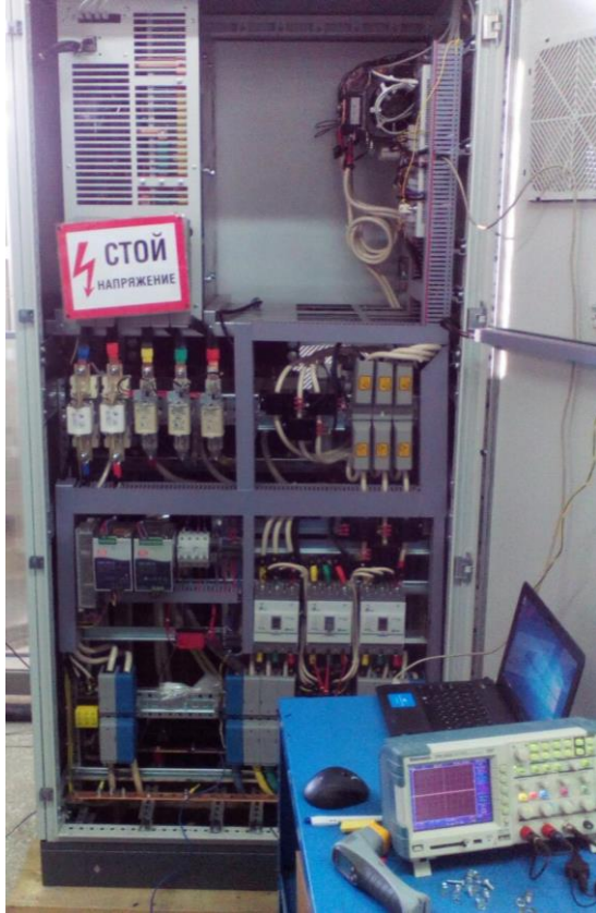
Рисунок 5.2 – Испытательная установка СНЭ 100 кВА: а) шкаф преобразователя; б) аккумуляторная батарея; в) дизель-генераторная установка
