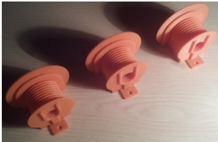
Рисунок А.2 - Каркасы вторичных обмоток управляющих трансформаторов
