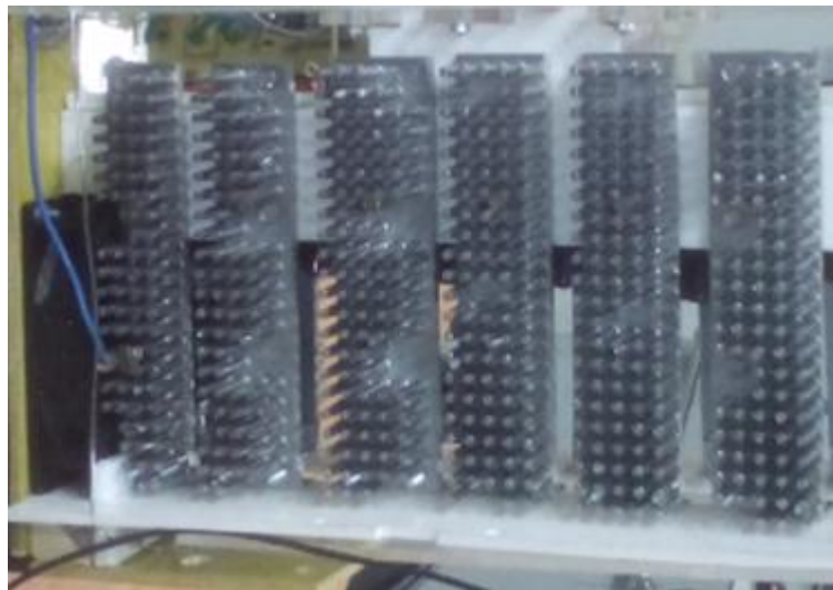
Рисунок 4.12. Радиаторы для охлаждения симисторов в устройстве ИРЗ
