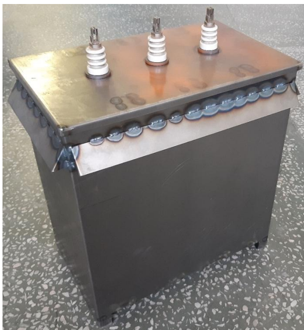
Рисунок 5.18 - Устройство глубокого ограничения
