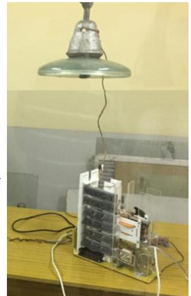
Рисунок 4.18. Схема экспериментальной установки а): 1-ЛАТР, 2 - защитный резистор, 3 – повышающий трансформатор, 4 – вывод ДЗЦ, 5 – вывод симисторного ключа; Фотография установки б)
