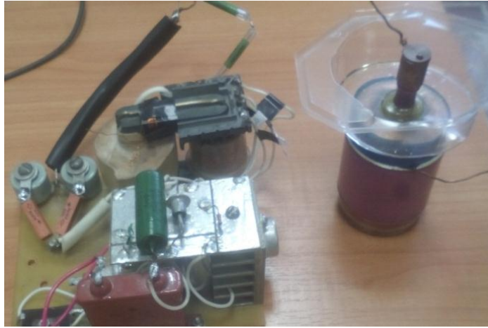
Рисунок 4.15. Фотография запальной схемы и РВУ-73
