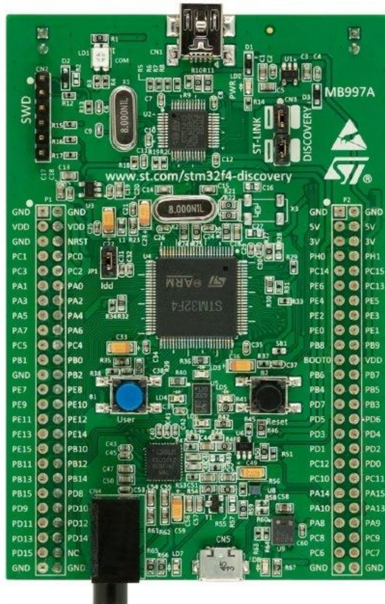
Рисунок 4.3 – Плата STM32F4 DISCOVERY
