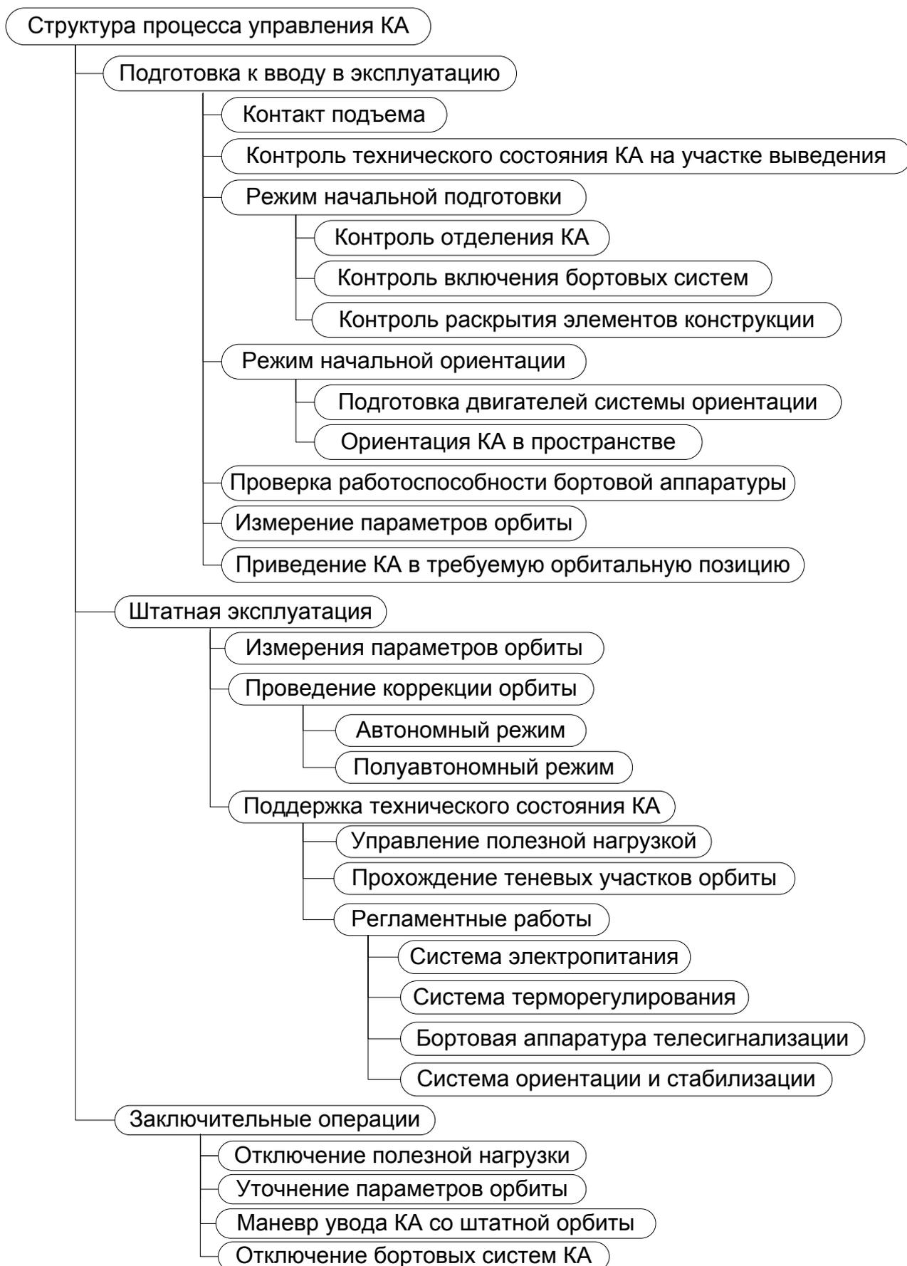
Рисунок 2.9 – Структура процесса управления КА
