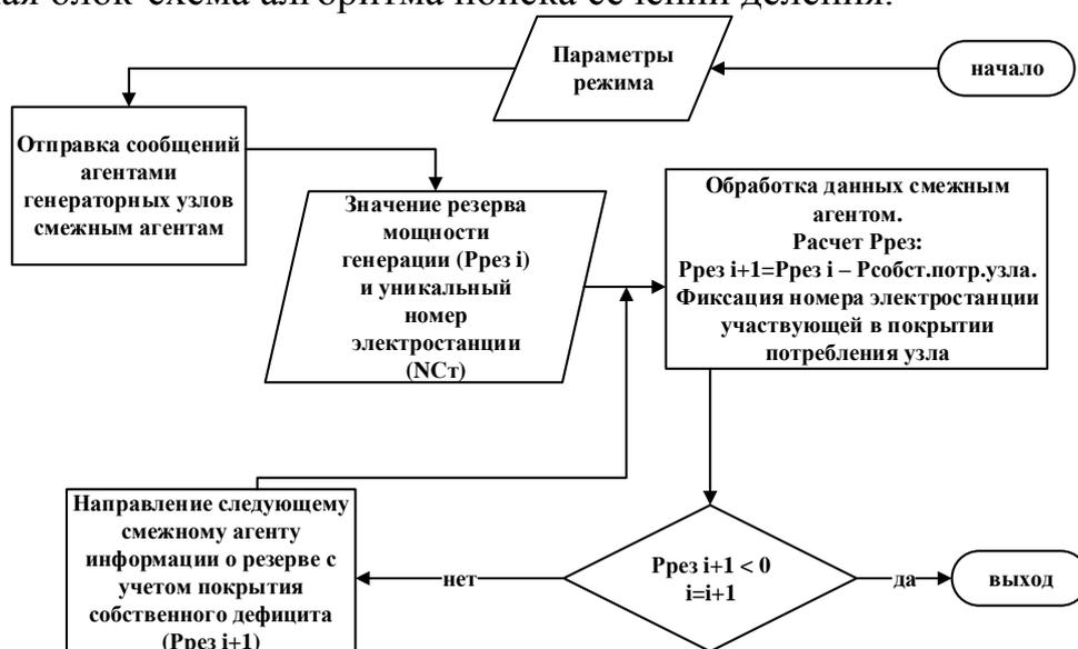
Рисунок 6 – Блок-схема поиска сечений деления при адаптивном делении
