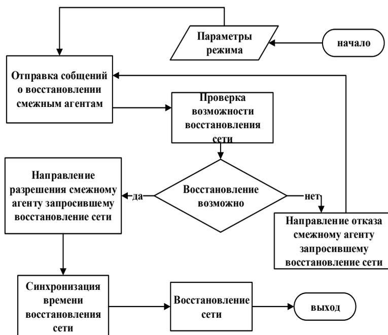
Рисунок 7– Блок-схема алгоритма восстановления сети
