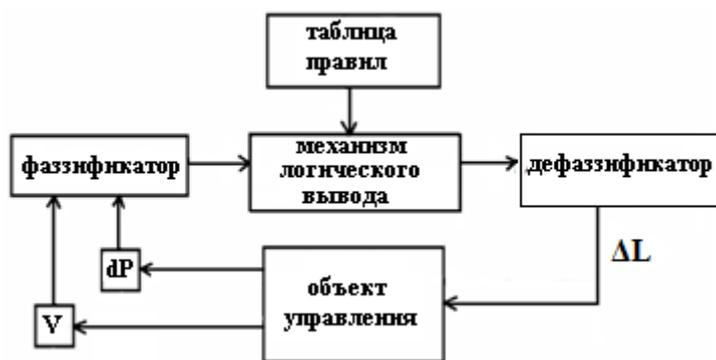
Рисунок 2 – Блок-схема нечеткого регулятора для изменения длины лопасти ветроколеса
