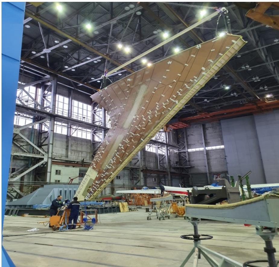
Рисунок 4.19 — Общий вид ОЧК изделия С-70 на упругой подвеске
