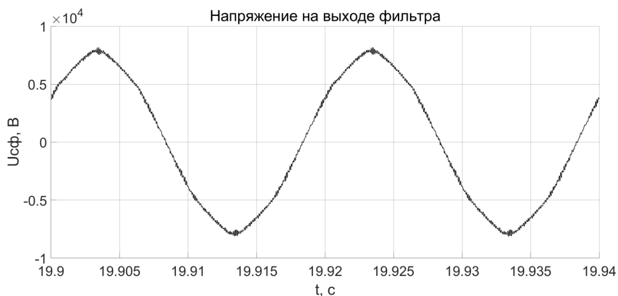
Рисунок 2.30 – Осциллограмма выходного напряжения каскадного СФ
