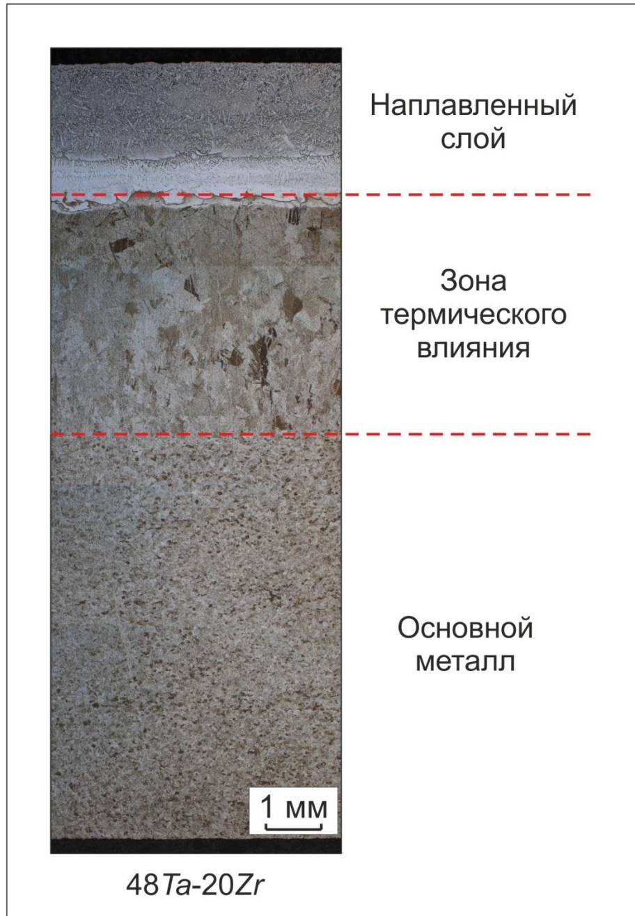
Рисунок 3.11 - Поперечное сечение титановой заготовки с двукратно наплавленным слоем
