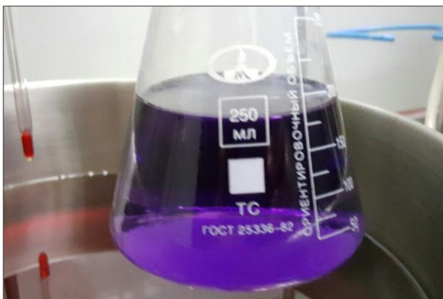
Рисунок 6.3 - Изменение цвета раствора после коррозионных испытаний технически чистого титана в кипящих 30 % растворах: а - соляной кислоты; б - серной кислоты
