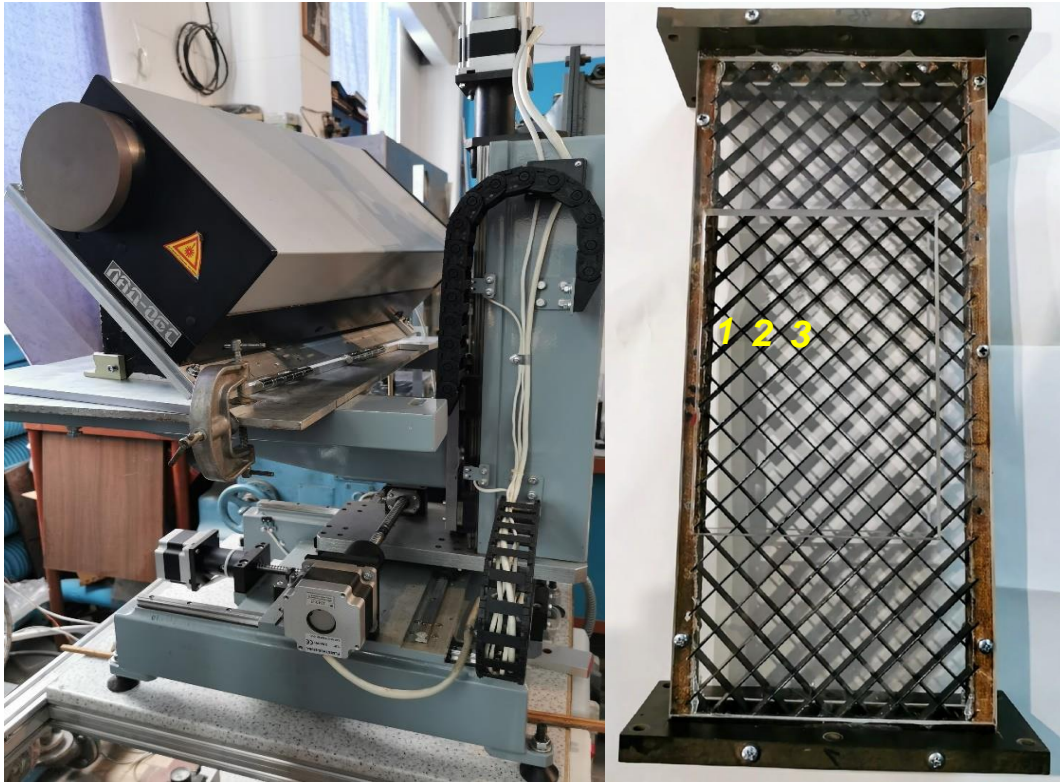
Рисунок 4.2 – Оптическая система LDA (а) и вихревая матрица (б)
