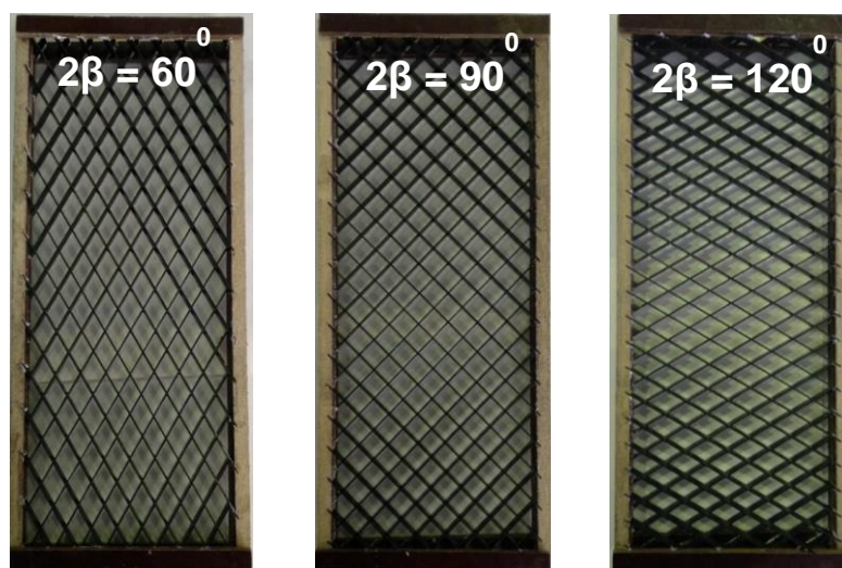
Рисунок 2.10 – Фото трех рабочих участков с компланарными каналами для изучения локальной аэродинамики в вихревых ячейках
