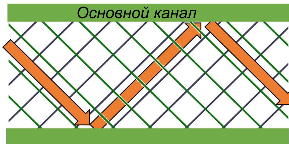
Рисунок 4.1 – Схема течения разделившего потока по подканалам вихревой матрицы
