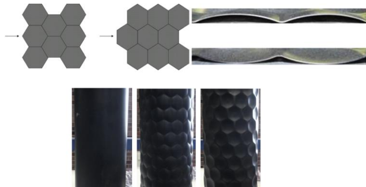
Рисунок 3.6 – Схема обтекания сот и фото опытных цилиндров с вогнутыми и выпуклыми сотовыми поверхностями [41-43]
