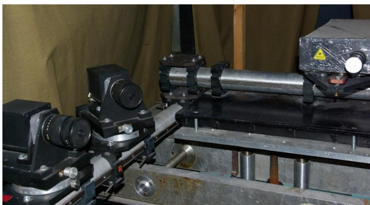
Рисунок 2.1 – Фото двух камер "Видеоскан" (слева) и твердотельного импульсного лазера (справа)
