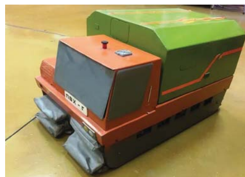
Экспонат из музея НГТУ. Макет колесного пневмохода из лаборатории бездорожного транспорта.
